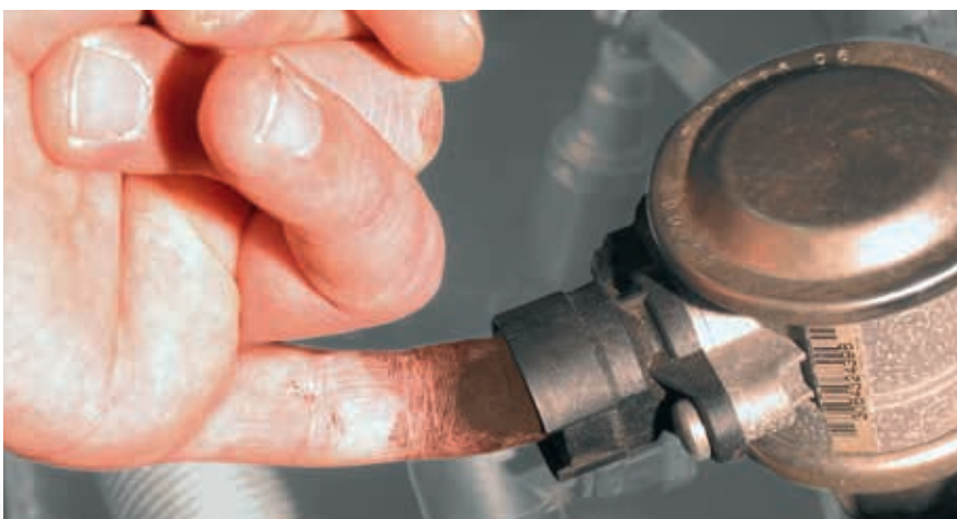
Schnellprüfung am Sekundärluftventil im BMW 520i (hervorgehoben)
