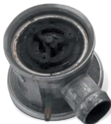
Uszkodzenie spowodowane przez skroplone spaliny
